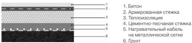
Рисунок 5. Пример конструкции подогреваемого пола в морозильной камере
